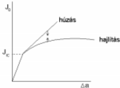
126. ábra. A húzásra vonatkozó J_0 eredmények mindig nagyobbak, mint a hajlításra vonatkozóak.
