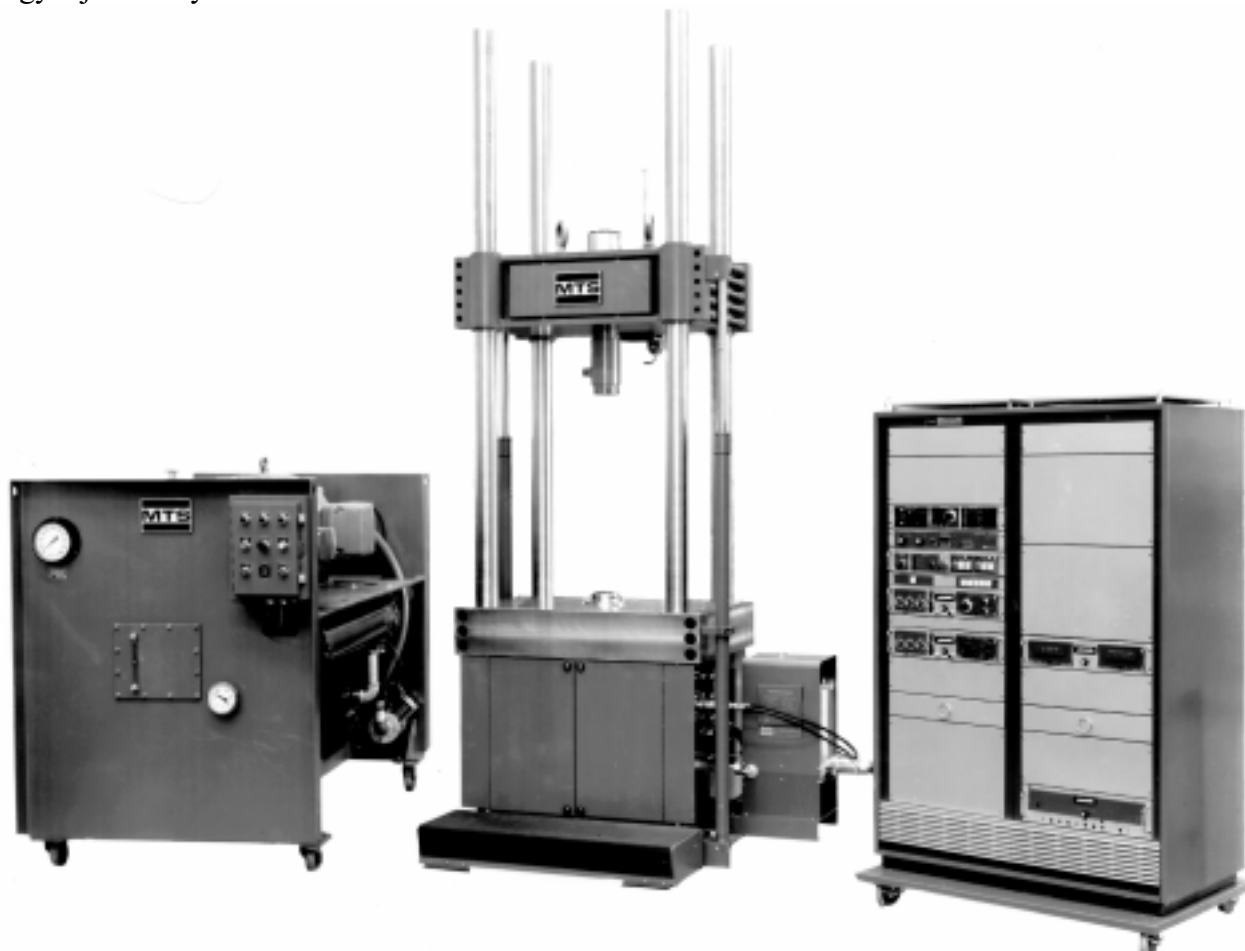
23. ábra. Az első generációs zárt vezérlésű MTS rendszer
