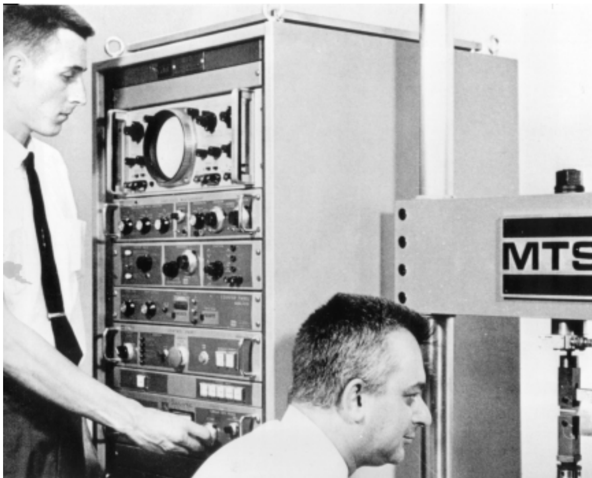
29. ábra. Az első PDP-8 mikroszámítógéppel összekapcsolt anyagvizsgáló berendezés (1968)
