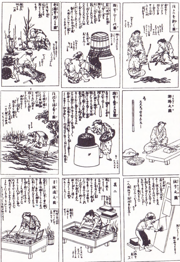
A papír készítése (japán ábrázolás nyomán); felső sor: a növényi nyersanyag begyűjtése, gőzölés, hántolás; középső sor: mosás, főzés, pépesítés; alsó sor: pépkeverés, merítés, szárítás
