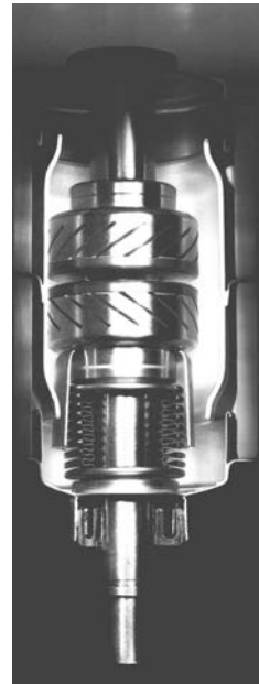
13. ábra. Vákuumos oltókamra U_n = 24 \text{ kV} , I_n = 2,5 \text{ kA} , I_{szak} = 31,5 \text{ kA} (SIEMENS)
