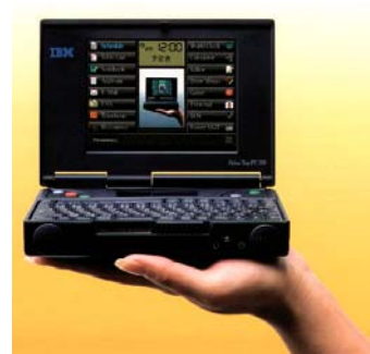
IBM PC110, 486SX alapú tenyészámítógép; DOS-, Linux- és Windows összeférő.
