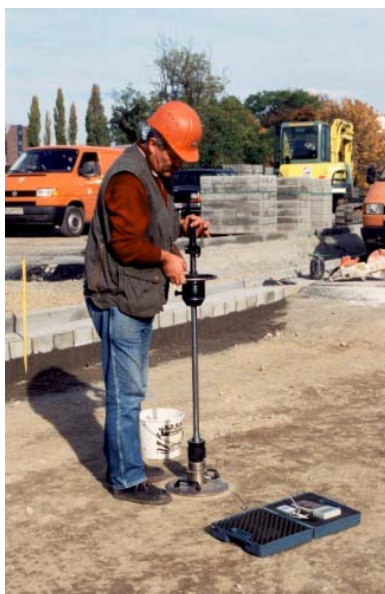
2. ábra Könnyű Ejtősúlyos Teherbírásmérő Berendezés
