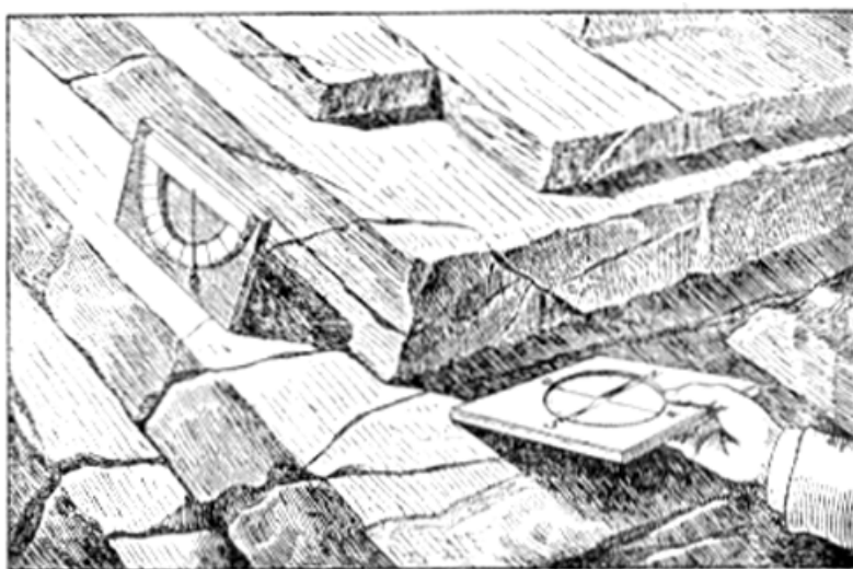
8. ábra. A földtani iránytű használata csapásirány és dülésszög mérésnél.
