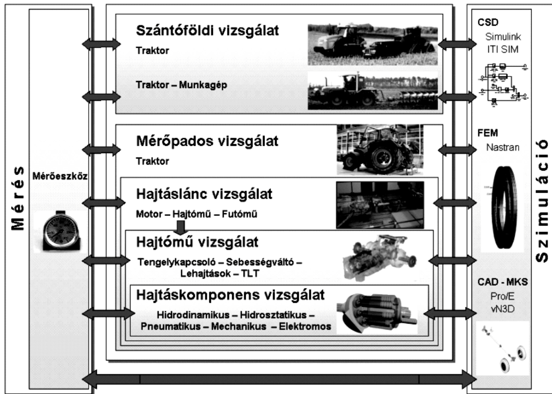
2. ábra Hajtásrendszer vizsgálata
