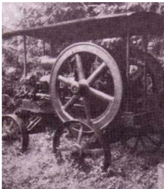
16. sz. kép: Otto rendszerű cséplőmozdony, a századforduló idejéből. A markaziak „csahosnak” nevezték.
