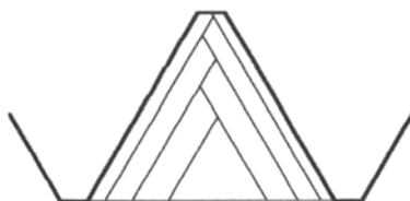
61. ábra Leválasztott forgácskeresztmetszetek
