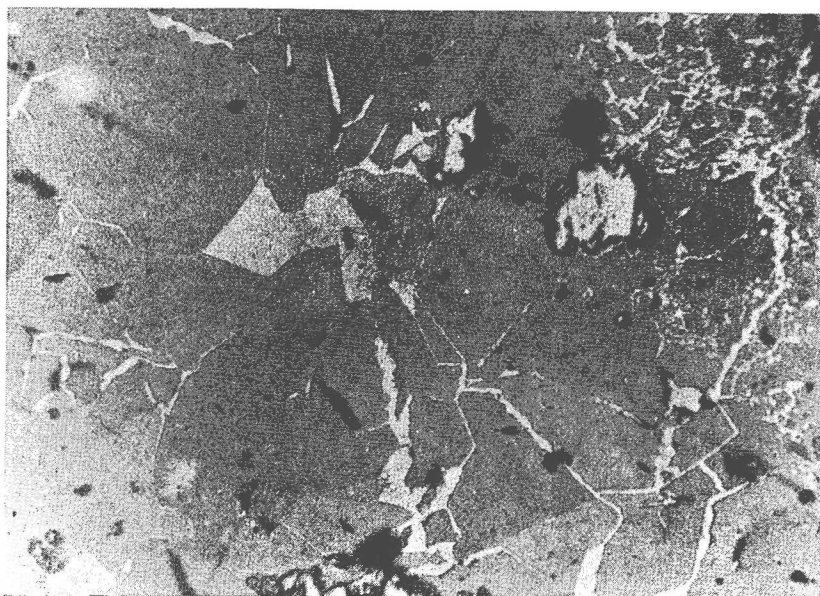
30. ábra. Sziderit-szemcsehatárok mentén kalkopirit. Ércsiszolat. Nagyítás: 50\times . || Nikol. (KOCH—GRASSELY nyomán)
