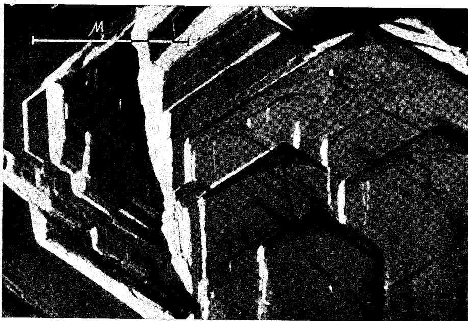
124. ábra. Kaolinit Végardóról. Replika-módszerrel készült elektronmikroszkópos kép. (G. Sz. GRICSAENKO felvétele a moszkvai Tud. Akadémia Elektronmikroszkóp Laboratóriumában)
