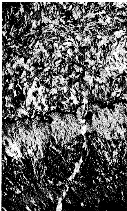
150. ábra. Kolloform szerkezet egy részlete. Alul kriptokristályos kriptomelán, felette hasonló megjelenésű piroluzit, e felett mozaik szerkezetű manganit-kristályhalmaz. Űrkút, lejtőszakna. Érecsiszolat. Nagyítás: 200 \times . + Nikol. (GRASSELLY GY. nyomán)
