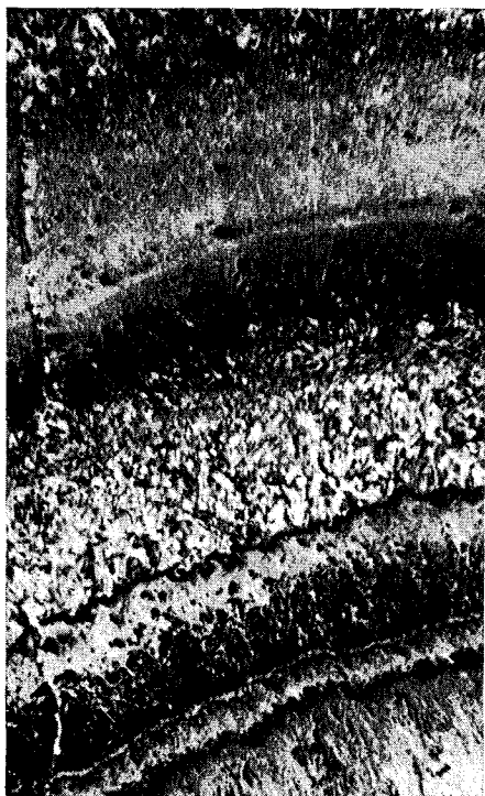
149. ábra. Koncentrikus-héjas, kolloform szerkezet egy részlete. Alul kriptokristályos kriptomelán, közepén — két gömbhéj közötti üregkitöltésként — mozaik szerkezetű manganit-kristályhalmaz. Űrkút, lejtőszakna. Érecsiszolat. Nagyítás: 100 \times . + Nikol. (GRASSELLY nyomán)
