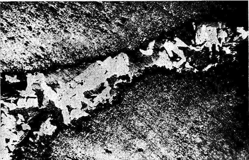
156. ábra. Durvakristályos manganit-üregkitöltés kriptomelánban. A manganit-fészket tűvasérc-zsinór határolja. Úrkút, lejtőszakna. Érecsiszolat. Nagyítás: 200\times . + Nikol. (GRASSELY Gy. nyomán)
