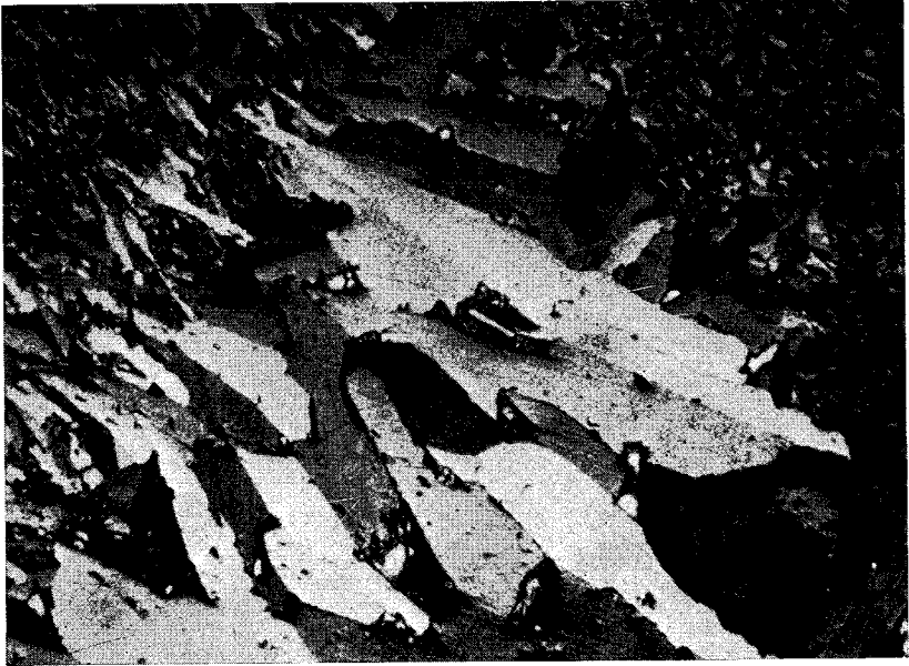
155. ábra. Durva kristályos manganit-kristályhalmaz mozaik szerkezetű, finomkristályos manganitban. Úrkút. Érecsiszolat. Nagyítás: 200\times . + Nikol. (GRASSELY nyomán)
