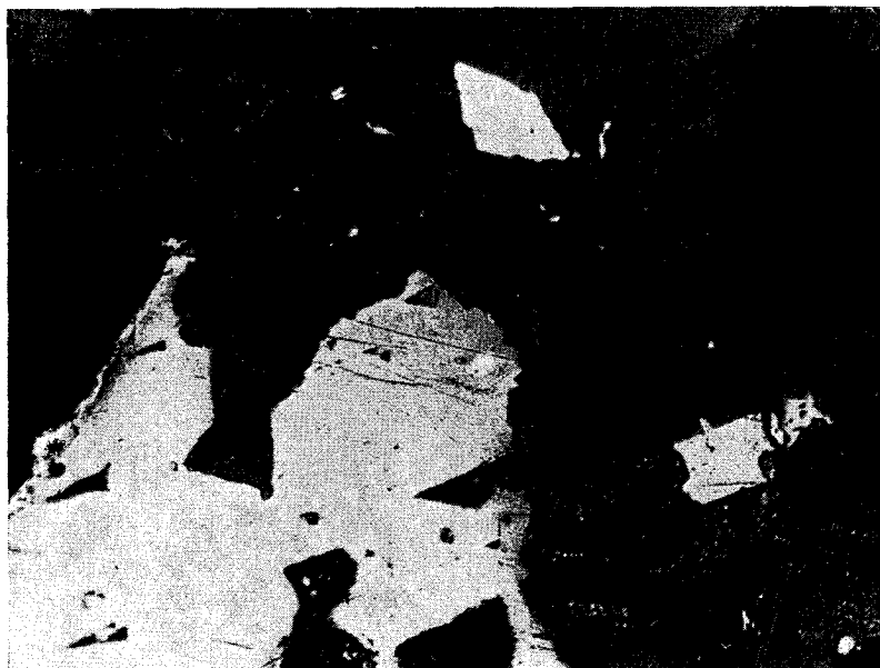
78. ábra. Arany (fehér foltoscska a kép közepén) szfalerit által kiszorított galenit-I-ben. Érecsiszolat, olajimmerzió. Nagyítás: 390 \times . || Nikol. (KOCH—GRASSELLY nyomán)
