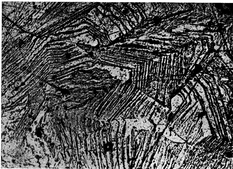
39. ábra. A termésréz légétetési felülete ritmikus kiválásáról tanúskodik. Rudabánya. Ércsiszolat. Nagyítás: 75 ×. || Nikol
