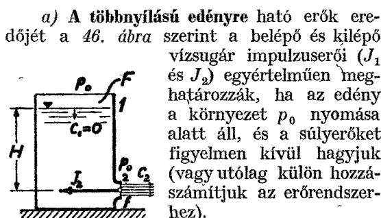
47. ábra. A kilépő vízszugár reakcióereje
