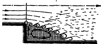
78. ábra. Áramlás a Borda-féle csőben
