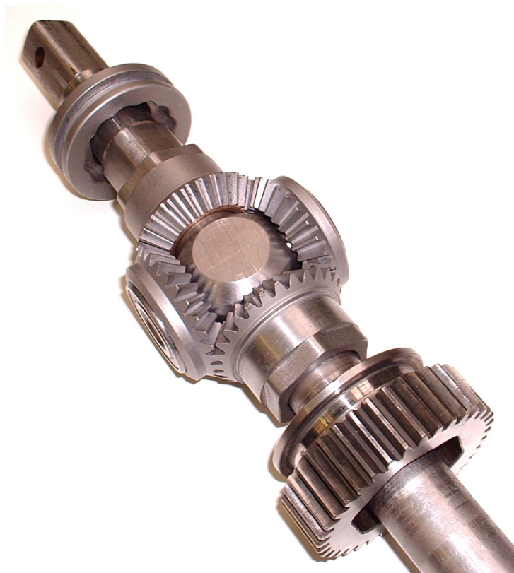
72. ábra Legyártott differenciálmű alkatrészek (ház nélkül)
