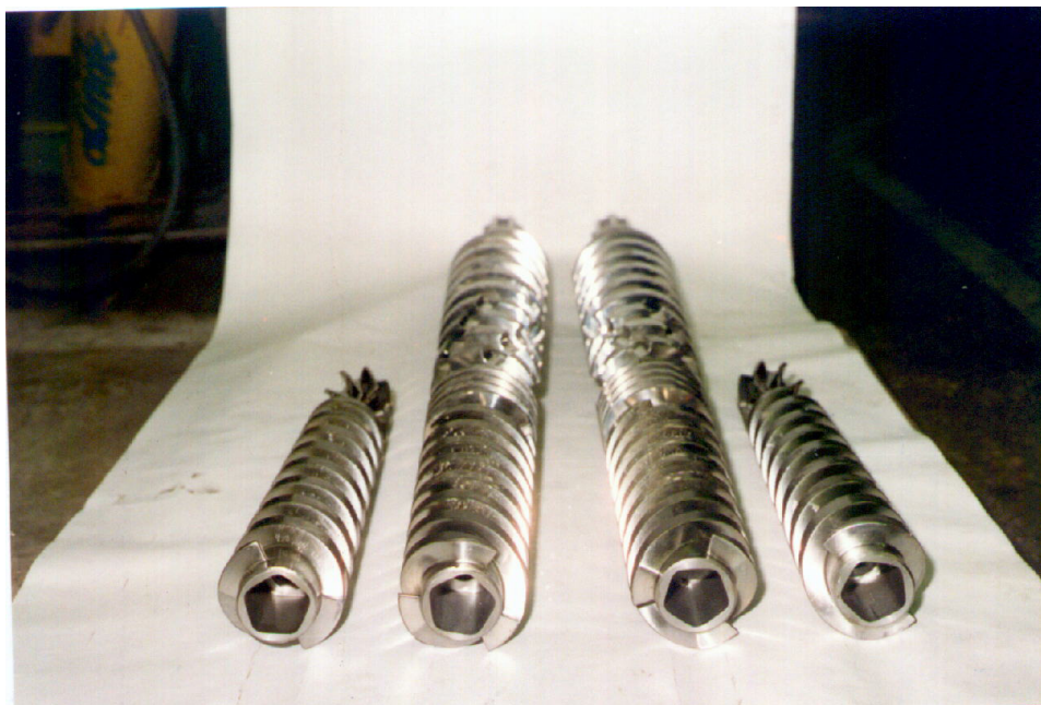
80. ábra Szerelésre előkészített csigaelemek
