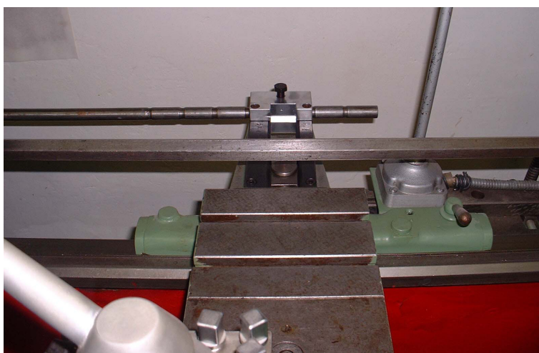
7. ábra A fogasléc hossz hossz-szánhoz csatlakoztatása
