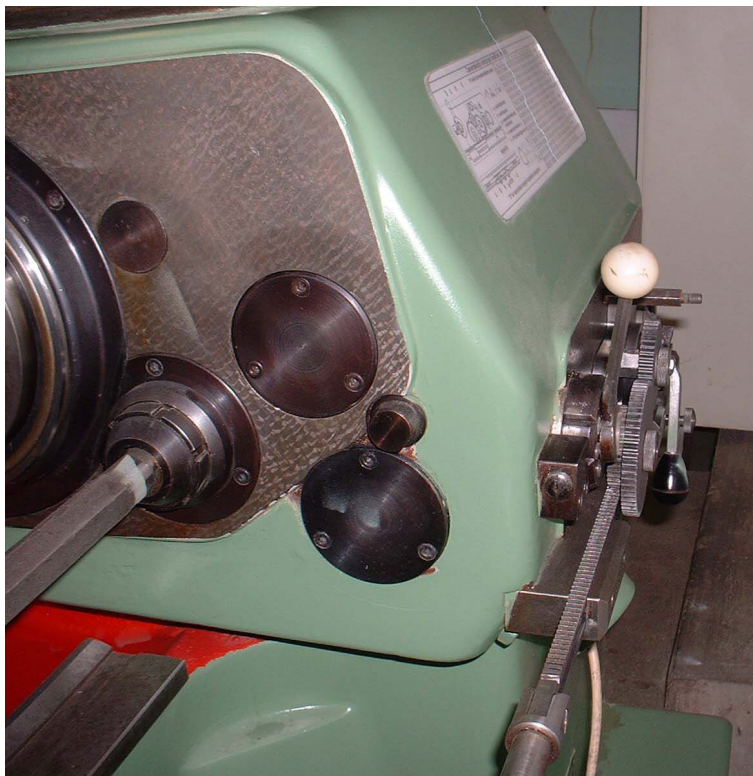
6. ábra A differentiálmű behajtás (fogasléc és fogaskerekes hajtómű)
