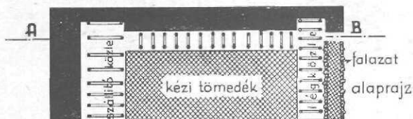
18. sz. rajz. Csapásmenti haladó pászt-fejtés, szélesítéssel.
