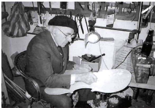
A PLASZTIKA ALAKÍTÁSA CSELLŐN LA SCULTURA DELLA TAVOLA DEL VIOLONCELLO FORMING A CELLO TOP
