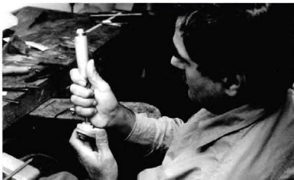
A CSIGA FARAGÁSA L'INTAGLIO DEL MANICO SCROLL CARVING
