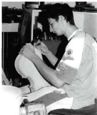
A HANGSZER-TEST CSISZOLÁSA
