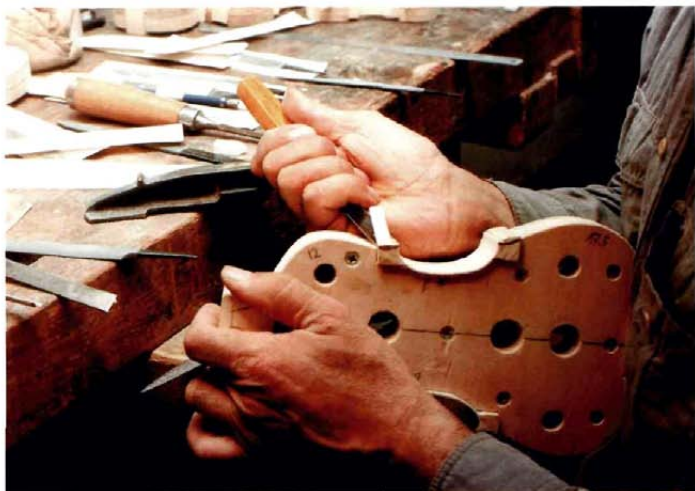
A TÖKE DERÉKSZÖGEZÉSE • LA SAGOMATURA DEI TASSELLI • SHAPING OF BLOCKS
