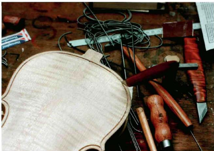
INTARZIÁZÁS KÖZBEN • LA FILETTATURA • THE PURFLING
