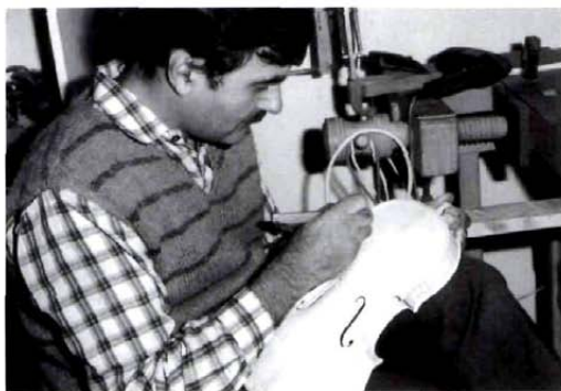
A TEST ÁTCSISZOLÁSA
