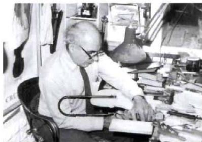
AZ „F”-EK KIVÁGÁSA TAGLIO DEI FORI ARMONICI CUTTING THE F HOLES
