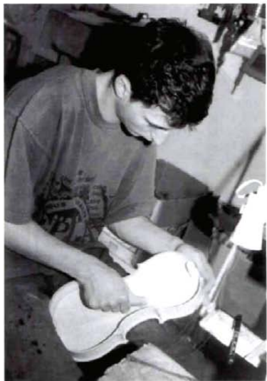
HEGEDÜBELSŐ TISZTÍTÁSA
