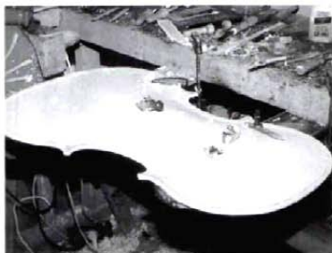
CSELLŐTETŐ PLASZTIKÁJÁNAK KIALAKÍTÁSA LA SCULTURA DELLA TAVOLA DI UN VIOLONCELLO SHAPING THE BELLY OF A CELLO
