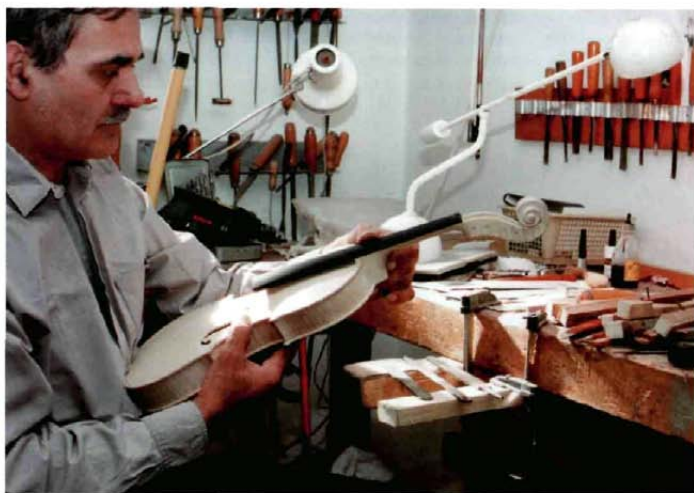
A NYAK ILLESZTÉSE • L'INCASTRO DEL MANICO • SETTING THE NECK
