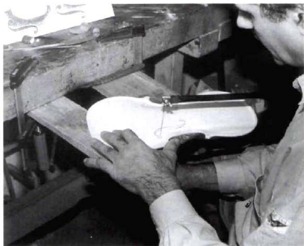
AZ „F”-EK KIVÁGÁSA L'INTAGLIO DELLE „FF” CUTTING THE „F”- HOLES
