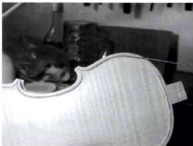
AZ INTARZIA (BERAKÁS) BETÉTELE EINCOLLATURA DEL FILETTO INSERTING THE INLAY
