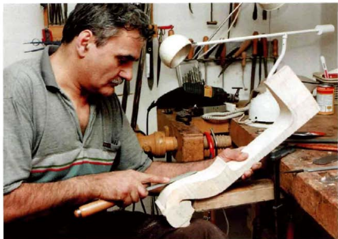
CSELLŐCSIGA FARAGÁSA KÖZBEN • L'INTAGLIO DELLA CHIOCCIOLA DEL VIOLINCELLO • CUTTING THE CELLO SCROLL
