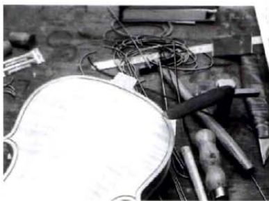
INTARZIA (BERAKÁS) HELYÉNEK KIVÁGÁSA LA FILETTATURA CUTTING OUT THE PURFLING CHANNEL
