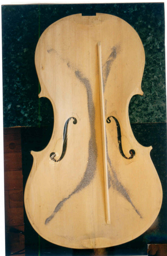
Csellótető Chladni-képei a 2. és 5. rezonáns frekvencián
