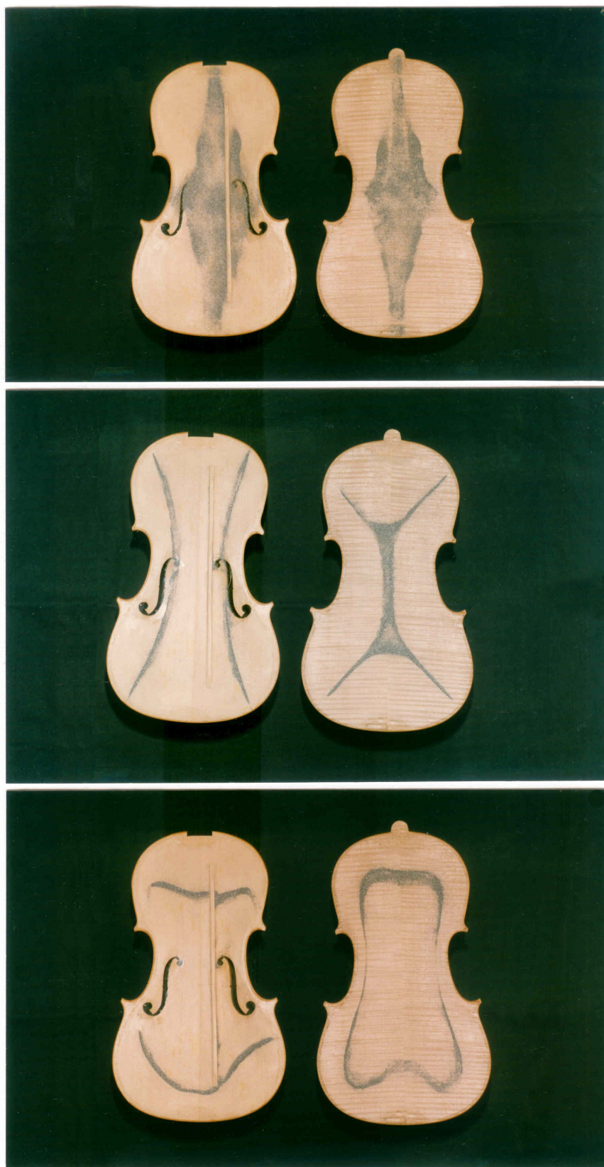
Hegedű tető- és hátlapjának Chladni-képei az 1. 2. és 5. rezonáns frekvencián
