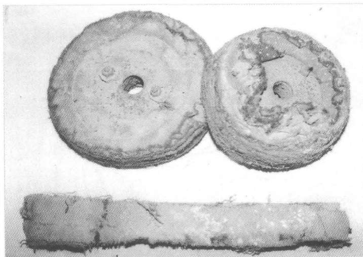
31. A slajfoló kerék katonapoztóból és a polírozó összevarrott vászondarabokból. Lent: a kézi fényesítéshez használt „hegedű”
