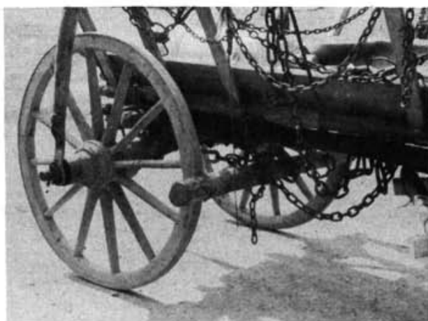
19. kép. Csatló- és fékező láncokkal, dörszölő fékkel felszerelt szekér. Répáshuta. Paládi-Kovács A. felv. 1979. (NKC. F 32. 728)
