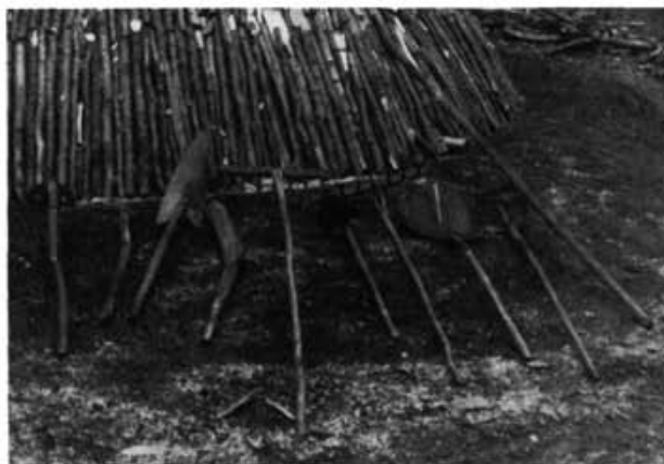
8. kép. Szénégető szerszámok: szénvonó, bontóvas, porolólapát, döngölő, szénhúzó gereblye, kapa, gereblye, szívlapát, lapát, gyújtóvessző. Petercsák Tivadar felv.
