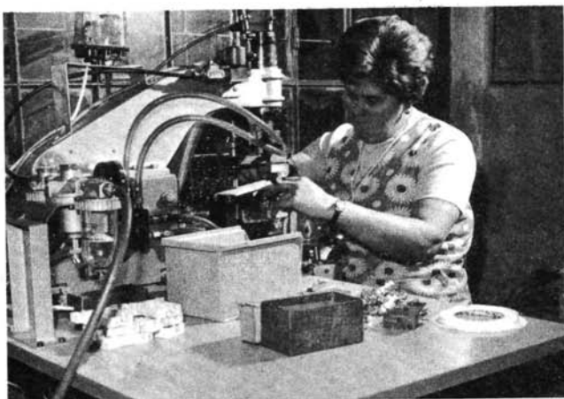
Siemens automata alkatrész pontheesztése, 1979.
