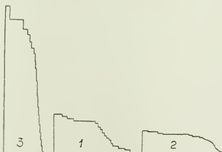
Fig. 3. 1. Diagramme d'une laine à carder: SSE. 2. " " " " à peigner: AA. 3. " " " " de racka: S. Ordon.: 1 mm = 0.2 gr. Abse.: 10×allong.
