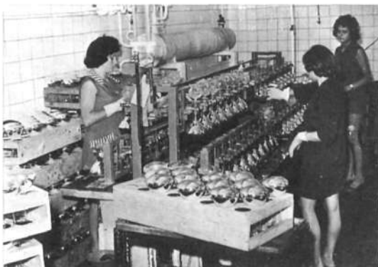
Infralámpa tükröző-bevonatának készítése, 1968 körül.
