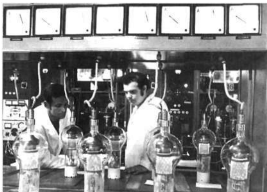
Nagyfeszültségű egyenirányítócső égetése, 1968 körül.
