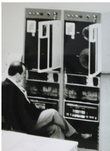
Girozentrale Wien 1971/72, Multiplex 80, Doppelanlage für Non-Stop Betrieb
