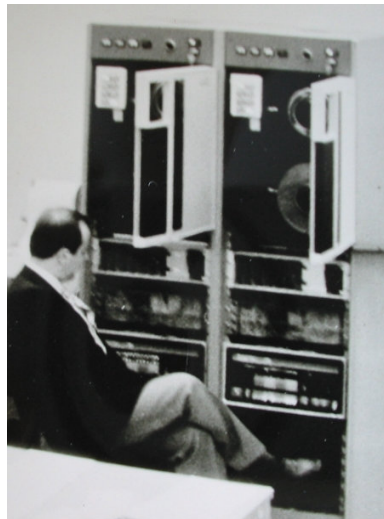
Girozentrale Wien 1971/72, Multiplex 80, Doppelanlage für Non-Stop Betrieb
