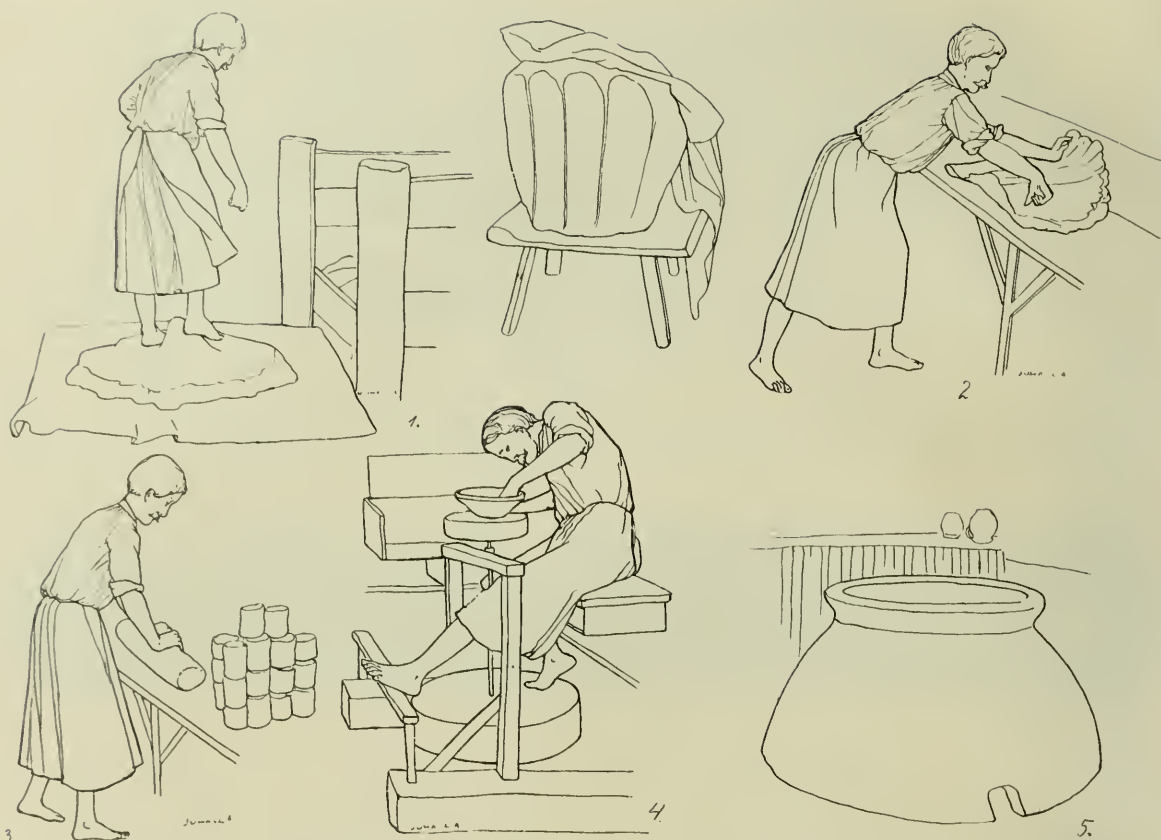
1. AGYAGTAPOSÁS. AGYAGVERŐSZÉK A BUTYÓKÁVAL. 2. AGYAGTERITÉS. 3. AGYAGRÖGÖZÉS. 4. A FAZEKAS KORONG. 5. ÉGETŐ KEMENCE. (306)
