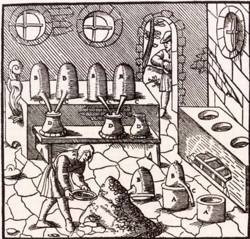
A higany lepárlása (metszet Agricola De re metallica című művében, 224. ábra)
