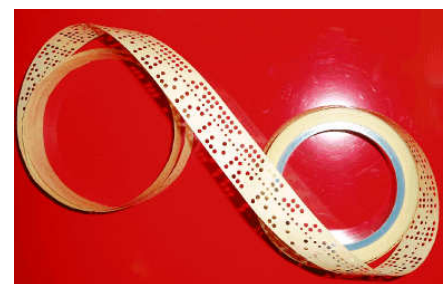
Fünf-Kanal-Lochstreifen mit fünf Löchern in jeder Spalte für Datenbits plus einer kleineren Transportlochung
