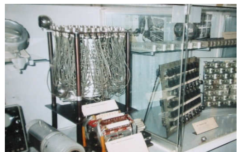
Magnettrommelspeicher des D4a - Die große Trommel (senkrecht mit Kabelgewirr) stammt vom ZRA1, die D4a Abwandlung auf dem gleichen Konstruktionsprinzip liegt vorn unten quer.
