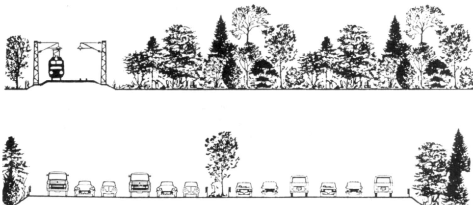
II.2.7.3.i. ábra: Területfoglalás azonos szállítási teljesítménnyel számolva korszerű vasút és autópálya esetén
