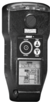
21. ábra Az MSA Sirius gázérzékelő készülék (Mine Safety Appliances Co., Cranberry Township, PA, USA).
