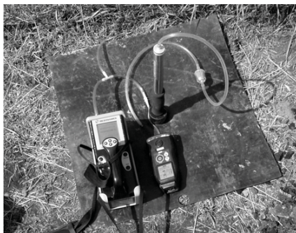
22. ábra Az együttesen alkalmazott Ecoprobe 5 talajlevegő-mintavevő egység és MSA Sirius gázérzékelő készülék.
