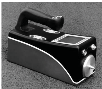
3. ábra Az Ecoprobe 5 talajlevegő-mérő készülék (RS Dymanics Ltd, Prága, Csehország)
