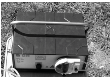
19. ábra Az Eijkelkamp talajgáz-mintavevő készülék (Eijkelkamp Agrisearch Equipment BV, Giesbeek, Hollandia) perisztaltikus szivattyúja (balra) és a berendezés műszaki rajza (jobbra). A hosszú ideig működtethető szivattyú talajlevegő és talajvíz mintavételére egyaránt alkalmas.
