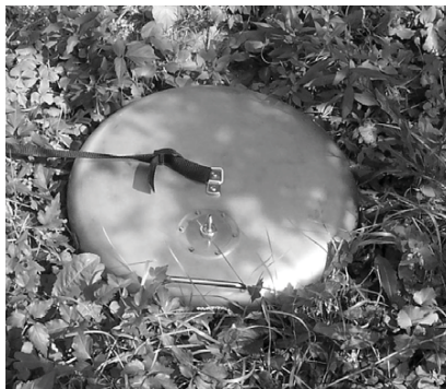
4. ábra Az Ecoprobe 5 készülék talajlevegő-mintavevő harangja (RS Dymamics Ltd, Prága, Csehország). Méretei: átmérő: 375 mm, felület: 11 dm 2 , űrtartalom: 4,5 dm 3 .
