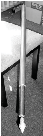
9. ábra Az Eijkelkamp készülék alapfelszereltségéhez nem tartozó „elvesző csúcsos” mintavevő szonda (Eijkelkamp Agrisearch Equipment BV, Giesbeek, Hollandia).
