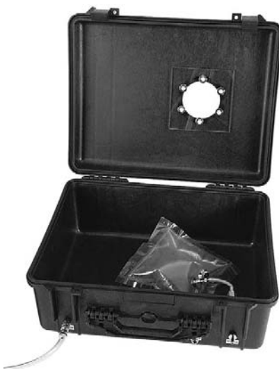
20. ábra Az Ecoprobe 5 készülék kiegészítőjeként alkalmazható vákuumbőrönd (SKC-West Inc., Fullerton, CA, USA).
