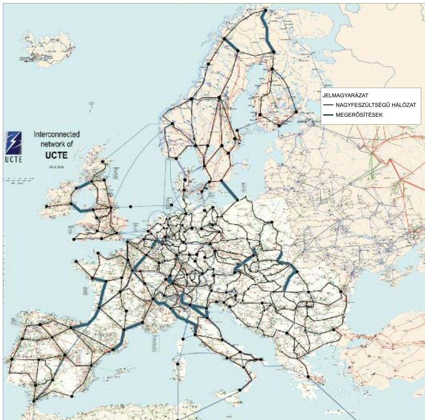
48. ábra: az európai nagyfeszültségű hálózat a megerősítendő kapcsolatok kiemelésével
