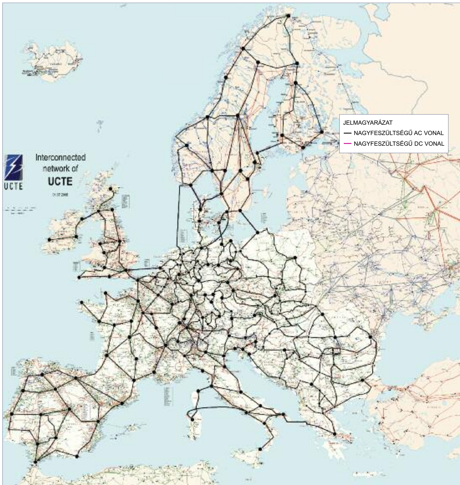
26. ábra: az európai nagyfeszültségű hálózat térképe az elektromos áramhálózat leegyszerűsítésével
