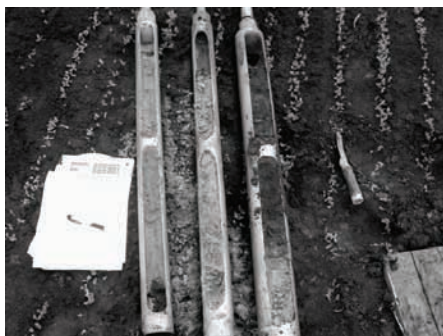
1. ábra Talajmintavétel talajfúrással magminta-vételre alkalmas Eijkelkamp ütve fúró berendezés segítségével
