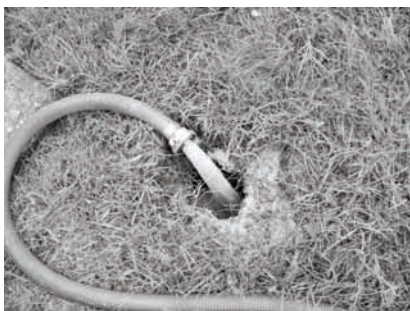
3. ábra Mikrobiológiai oltóanyag kijuttatása az Orosháza I. tesztterületen szénhidrogének intenzifikált lebontására
