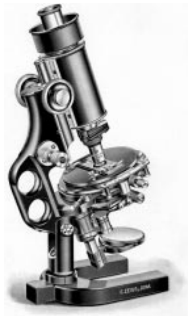
1. ábra. Az Abbe-mikroszkóp (Forrás: Felix Auerbach: Das Zeisswerk und die Carl-Zeiss-Stiftung . 1903.)
