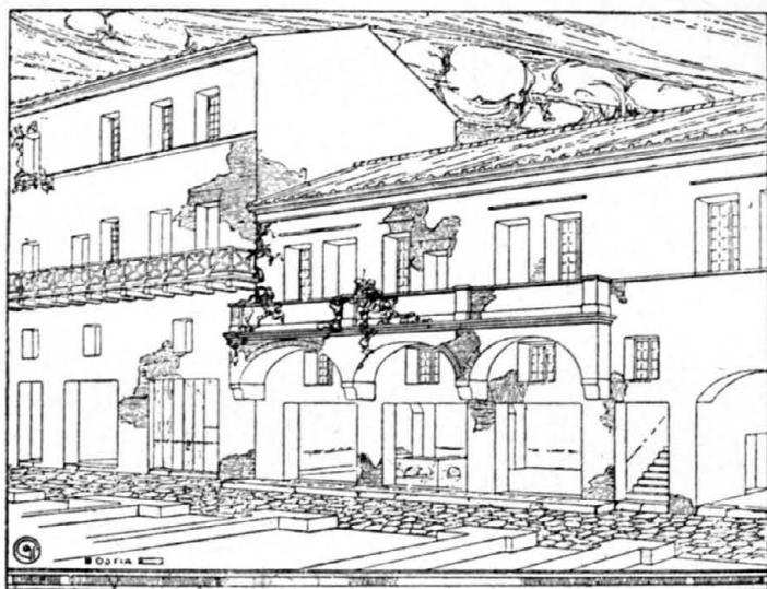
(97. kép.) RÓMAI HÁZ OSTIÁBÓL, rekonstrukció. A Vitruviusnál említett többemeletes, ajtókkal, ablakokkal és erkélyekkel tagolt nagyvárosi római lakóház első példáit az ostiai ásátások hozták felszínre. Kétségtelen, hogy a további fejlődést meghatározó, középkori román palotaépítéset gyökérszállai ezekre a kezdeményezésekre nyúlnak vissza.
