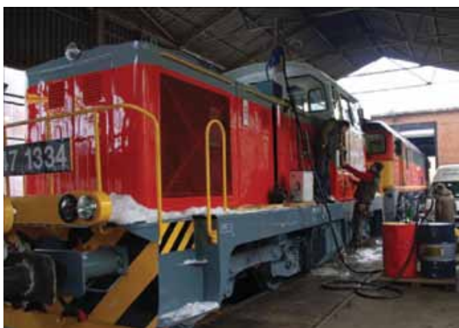
A MÁV már több mozdonyát is ellátta részecskeszűrővel, aminek eredményeként a részecskekibocsátásuk több mint 99 százalékkal csökkent! Forrás: M47 sorozatú dízelmozdony károsanyag kibocsátásának csökkentése részecskeszűrő berendezés felszerelésével, Vasútgépészet 2011/2, http://vasutgepeszet.hu/wp-content/uploads/2011/07/201102_15-23_vegl.pdf , http://imex.filtertecnica.hu/hirek/olvas/2011-08-04-vasutgepeszet-2011-2
