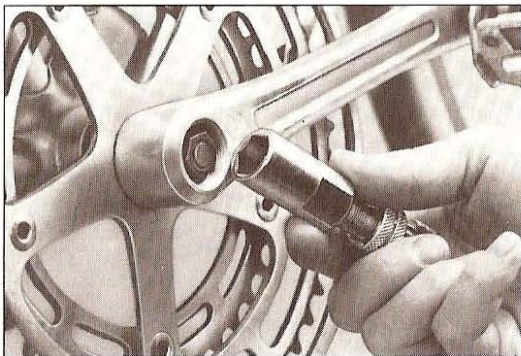
25. ábra. Hajtókarleszedő szerszám szögletes tengelyű hajtóműhöz
