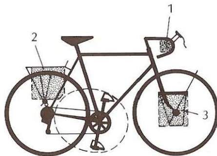
72. ábra. Ideális teherelosztás Jim Blackburn szerint 1 egészen kicsi kormánytáska; 2 közepes méretű hátsó oldaltáskák (amennyire lehet előre vívve); 3 közepes méretű, a kerékkal koncentrikus első oldaltáskák
