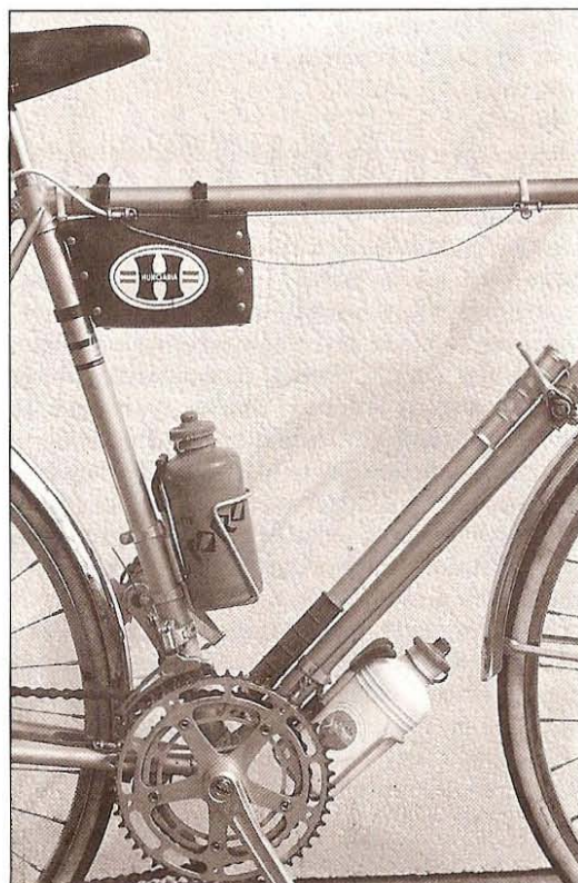
63. ábra. Pumpa, szerszámtáska és vizeskulacsok lehetséges elhelyezése túrakerékpáron
