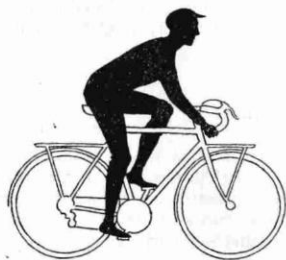
10. ábra. A 17"-es Moulton AM7 — a kempingbiciklinél kisebb kerekei ellenére — felveszi a versenyt a 27"-es szingós versenygépekkel is. A magyarázat: nagynyomású gumik és rugózott kerékfelfüggesztés (lásd a 23. ábrát). Amint látjuk, a biciklista a szokásos helyzetben ül az AM7-en is. (Alex Moulton engedélyével)
