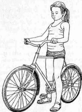
28. ábra. A vázmagasság ellenőrzése biztonsági szempontból. Ez a bicikli lehetne valamivel alacsonyabb is
