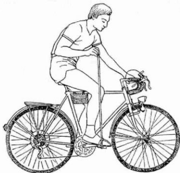
38. ábra. A nyereg vízszintes irányú helyzetének ellenőrzése
