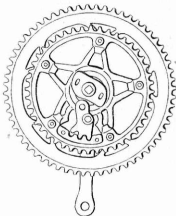
6. ábra. A Powercam hajtómű
