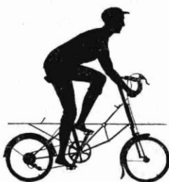
10. ábra. A 17"-es Moulton AM7 — a kempingbiciklinél kisebb kerekei ellenére — felveszi a versenyt a 27"-es szingós versenygépekkel is. A magyarázat: nagynyomású gumik és rugózott kerékfelfüggesztés (lásd a 23. ábrát). Amint látjuk, a biciklista a szokásos helyzetben ül az AM7-en is. (Alex Moulton engedélyével)
