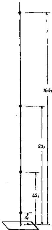
136. kép. s_1 , 4s_1 , 9s_1 , 16s_1 távolságokban felfüggesztett golyók szabad- esése.
