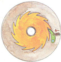
Modern versenybicikli racsnija, amely a nevét a benne kettyegő cseles szerkezetről, a kilincsműről kapta
