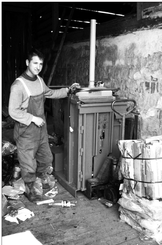
9. kép Kartonpapír és műanyagflakon préselésére alkalmas gép, mellette a kezdeményezés egyik szervezője. (Murányi Veronika fotója, 2006)
