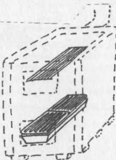
Sparheltkályha kettős ráccsal (felül sp., alul kályha, a szerző építette, 8 eFt)
