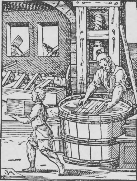
32. ábra. Papirosalmi munkálkodás a tizenötödik században. Kínában ősrégi foglalkozás volt a bambuszrostból, eperfafelevélből és selyemhulladékból való papirosgyártás. Az újkor kezdetén ez a mesterség hozzánk is elkerült, s bővízü patakok mentén elég szép számmal voltak papirosalmaink. A papiros alapanyagául szolgáló rongyot kallózták, péppé verték s aztán vízjegyes szitával „merítve”, közben esetleg enyvezve is, megszáritották, majd pedig présbe tették.
