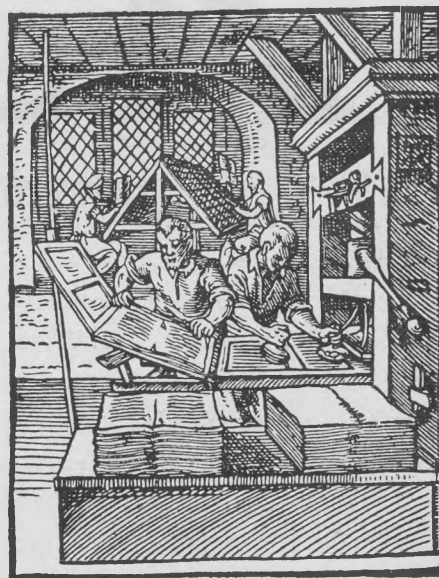
35. ábra. Munkálkodás az ősi kézsajtón. Amman Jost rajza 1568-ból. A régi idők nyomtató munkása mindig párosával dolgozott. Egyik volt a „labdák mestere”, a másik a „sajtómester”. Az elsőnek a föladata volt a forma gondos és egyenletes festékezése, ami pedig az akkori időkben nem volt könnyű dolog; a sajtómester pedig a közben befestékezett formára ráillesztette a papírost (a punktura túli jól láthatók az ábránkon), leeresztette a rámát és „deklit”, a taligát a tégely alá hajtotta, s a fordítókart kihúzva, végezte a nyomtatást.
