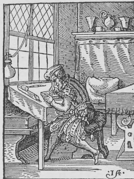
34. ábra. A fametsző a munkája közben. A fametszés művészete annyira szerves összefüggésben volt a könyvnyomtatással, hogy a nagyobb nyomdaműhelyeknek megvoltak a maguk rendes fametsző alkalmazottai is, akik kicsiny készülékkel rendszerint körtefába metszték az illusztrálásra vagy dekoratív célra elébük adott rajzokat. Főleg a tizenhatodik század fametszői oly csodálatos művészi készségről tettek tanuságot, hogy ma jóformán senki sem tud a nyomukba jutni.
