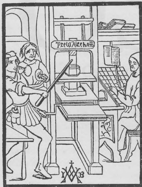
7. ábra. A nyomtatósajtó legrégebbi ábrázolása. Gutenberg sajtója is ilyenforma lehetett. Ábránk Badius Jodocus Ascensius francia könyvnyomtatónak nyomdajegye volt az 1498 körüli időktől kezdve. Badius Lyonban nyomdászkodott, majd Párizsba telepedett át, s ott tevékenykedett 1535-ben történt haláláig. Vejei révén törzsapja lett három világhírű nyomdászcsaládnak: a Vascosan-, Roigny- és Estienne-családoknak. A sajtó keresztgerendáján levő, hibás ortográfiájú latin fölirat („Praelum Ascensianum”) magyarra lefordítva ennyit jelent: „Ascensius sajtója”.
