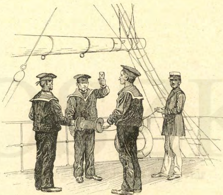
LOGG! (MENET-GYORSASÁG MÉRÉSE.)
