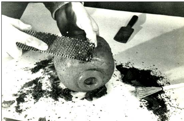
A felület alakítása reszelővel
