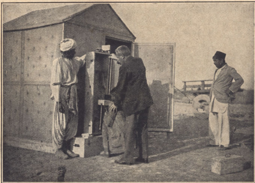
A torziós ingát kiemelik ládjából. Az angol kormány egyik legnagyobb olajvállalata felkérésére a Bárány Eötvös Lóránd Geofizikai Intézet — vezetője Pekár Dezső dr. — végzett Indiában, Kahirpur bennszülött államban geofizikai méréseket
