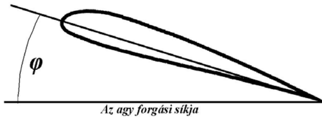
IV.9. ábra A lapátelelem beállítási szög értelmezése
