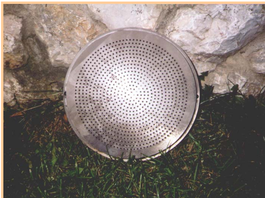
37.1 ábra Legyártott műanyag granuláló extruder fej (tervezés, gyártástervezés, gyártásirányítás)
