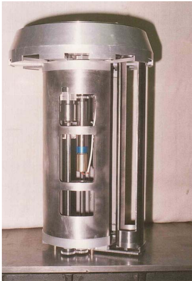
32.1 ábra Űrkemence kapszula adagoló berendezésének szerelése (gyártástervezés gyártásirányítás)
