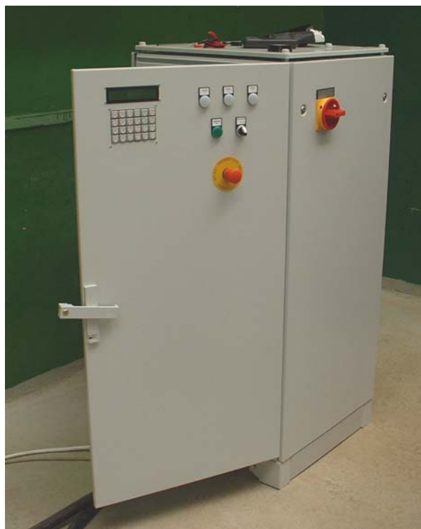
87.1 ábra Az kifejlesztett számítógépvezérlésű anódvizsgáló berendezés
