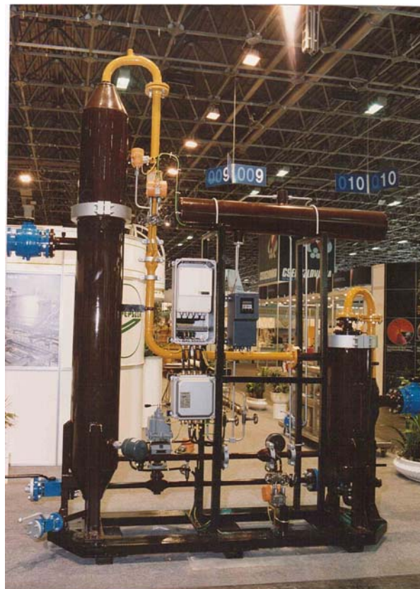
28.3 ábra Olajkúthozammérő berendezés a Budapesti Nemzetközi Vásáron ,1991.
