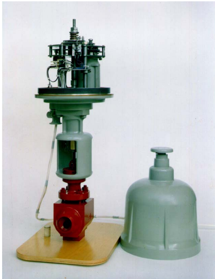
20.1 ábra A kifejlesztett prototípus villamos végrehajtó szerv (EMI-87)
