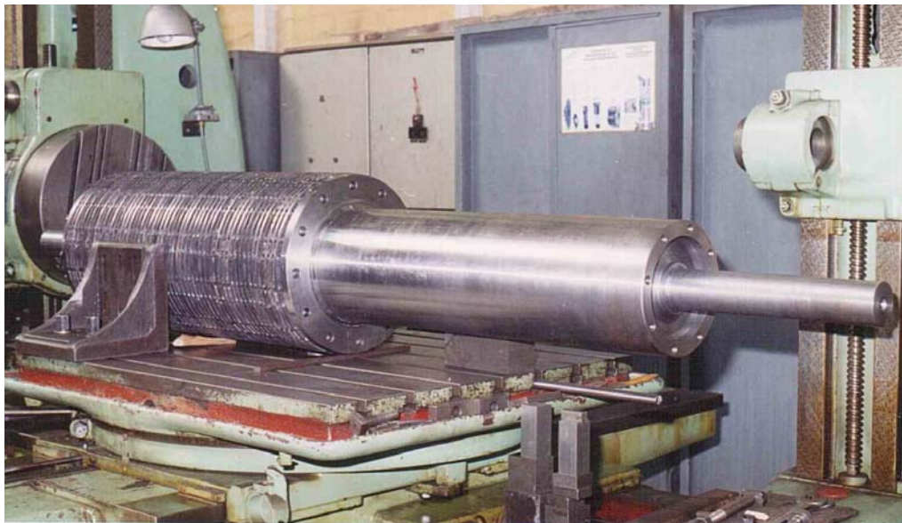
45.2 ábra Kocsányozógép. Rotor szerelése
