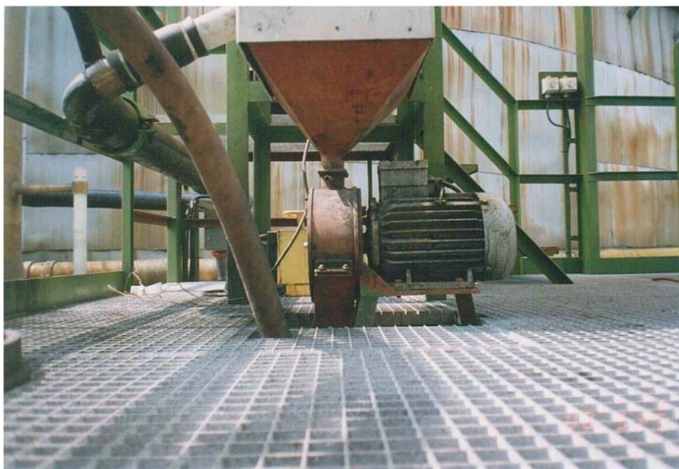
69.2 ábra Hg-os hulladék feldolgozó berendezés kalapácsos daráló
