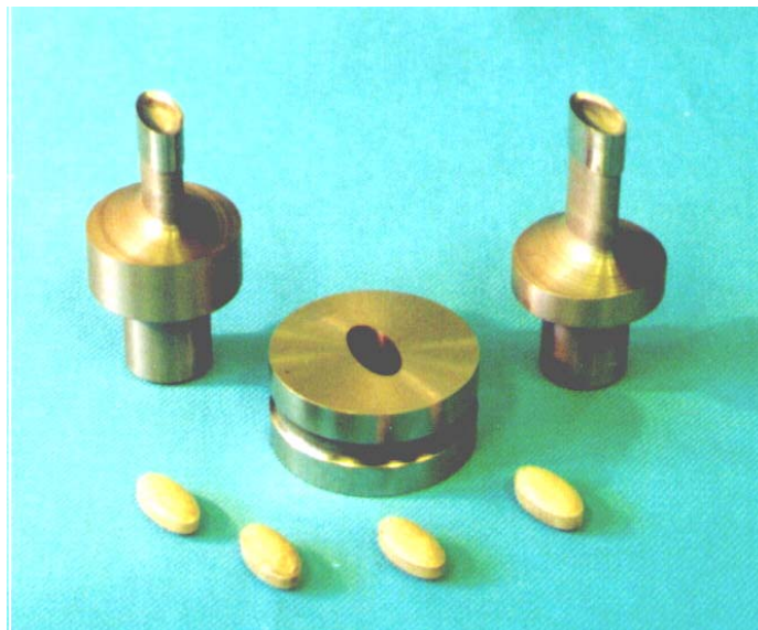
53.3 ábra Augmentin 375 mg laboratóriumi tablettázó szerszám (BIOGÁL Rt.)
