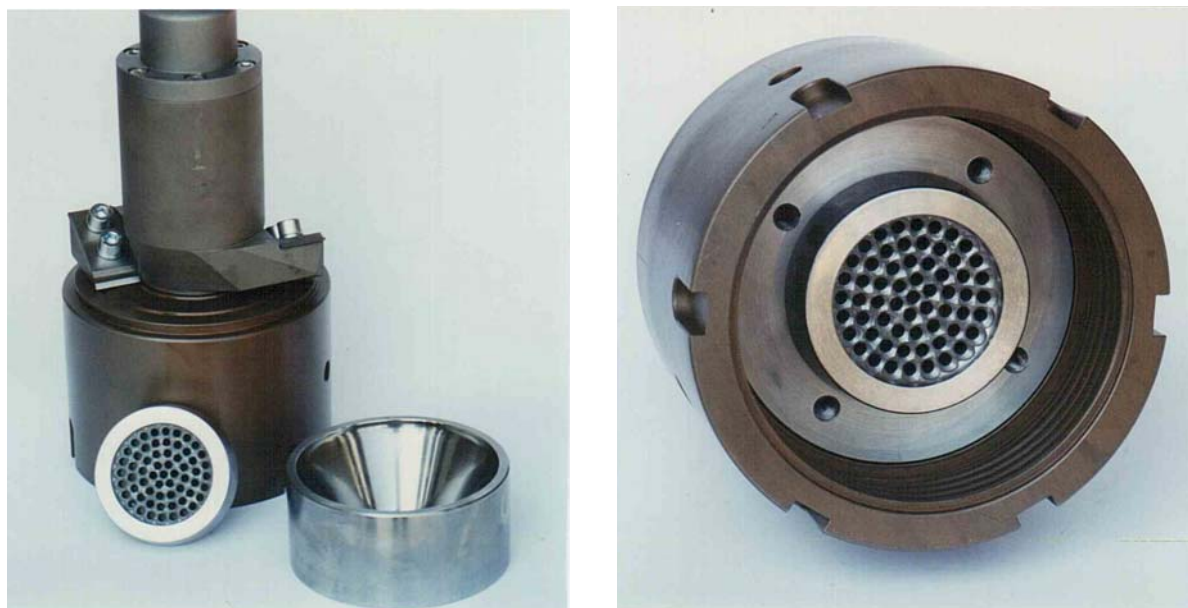
66.2 ábra A legyártott BT 50 granuláló szerszám
