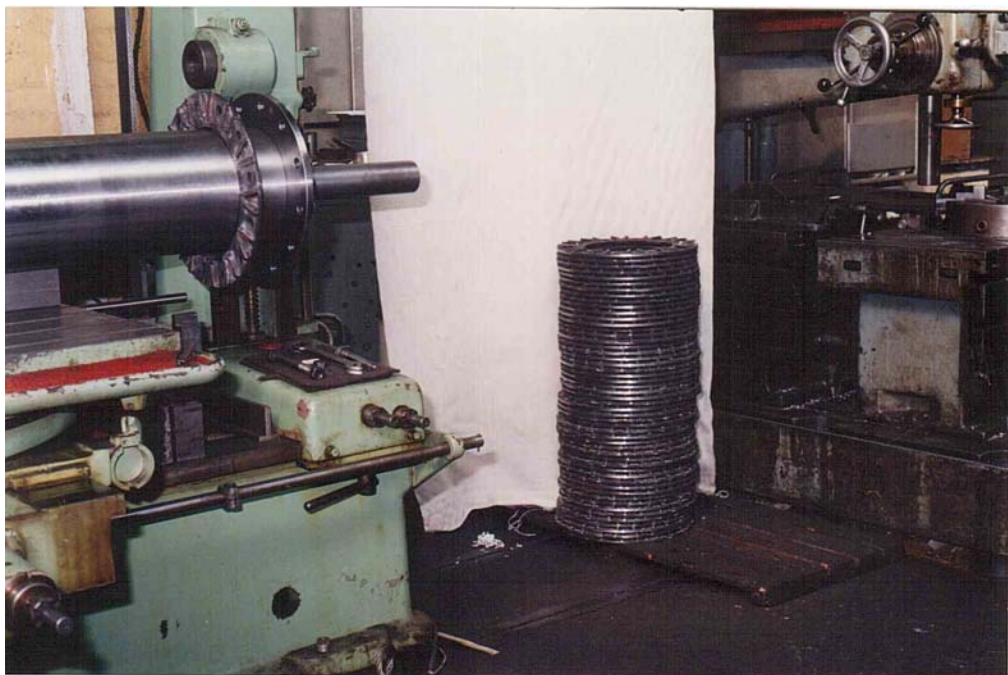
45.1 ábra Kocsányozógép. Szerelésre előkészített forgórész tárcsák
