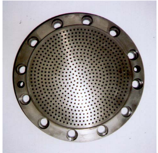
62.1 ábra BUSS Ko-Kneter típusú granuláló fej, beömlő és kilépő oldal
