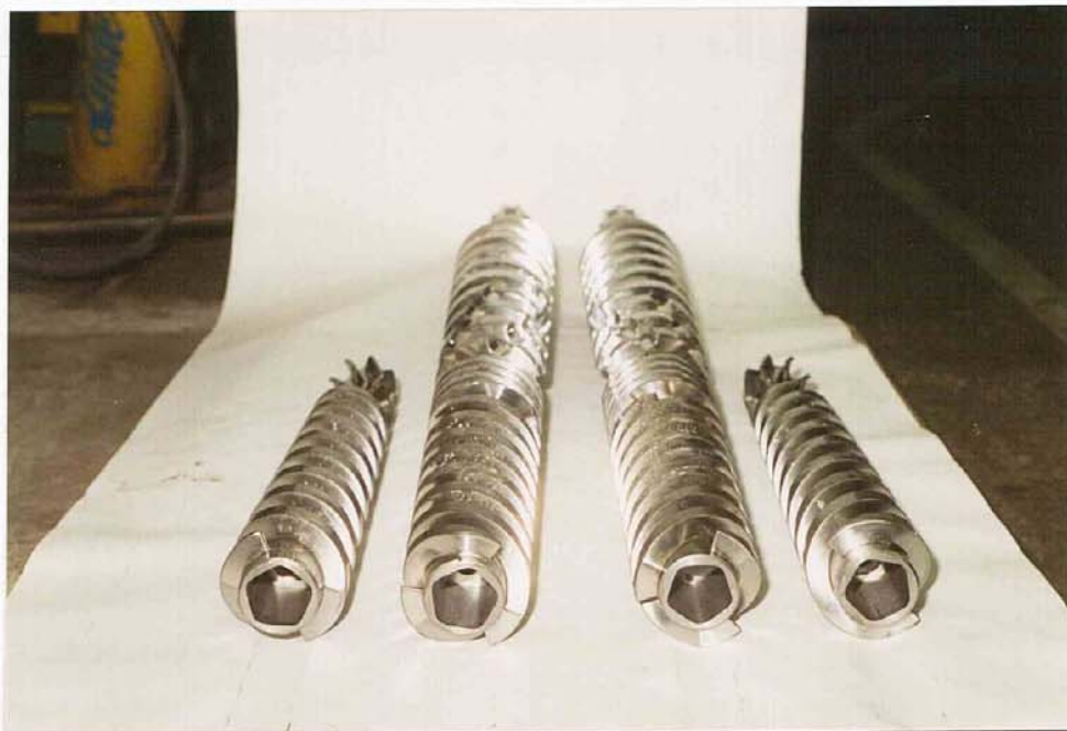
2-17. ábra Szerelésre előkészített csigaelemek
