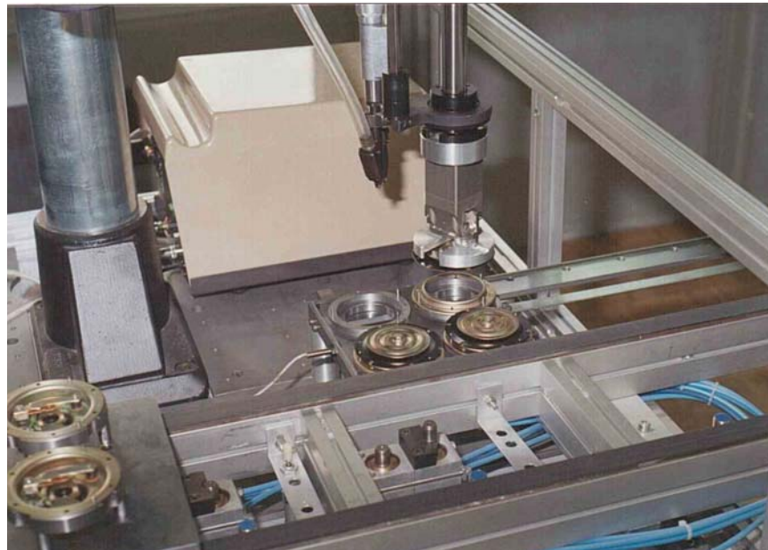
31.1 ábra Tányérkürt robotos végszerelése (tervezés, készülék és robotkéz tervezés, gyártástervezés, beüzemeltetés)
