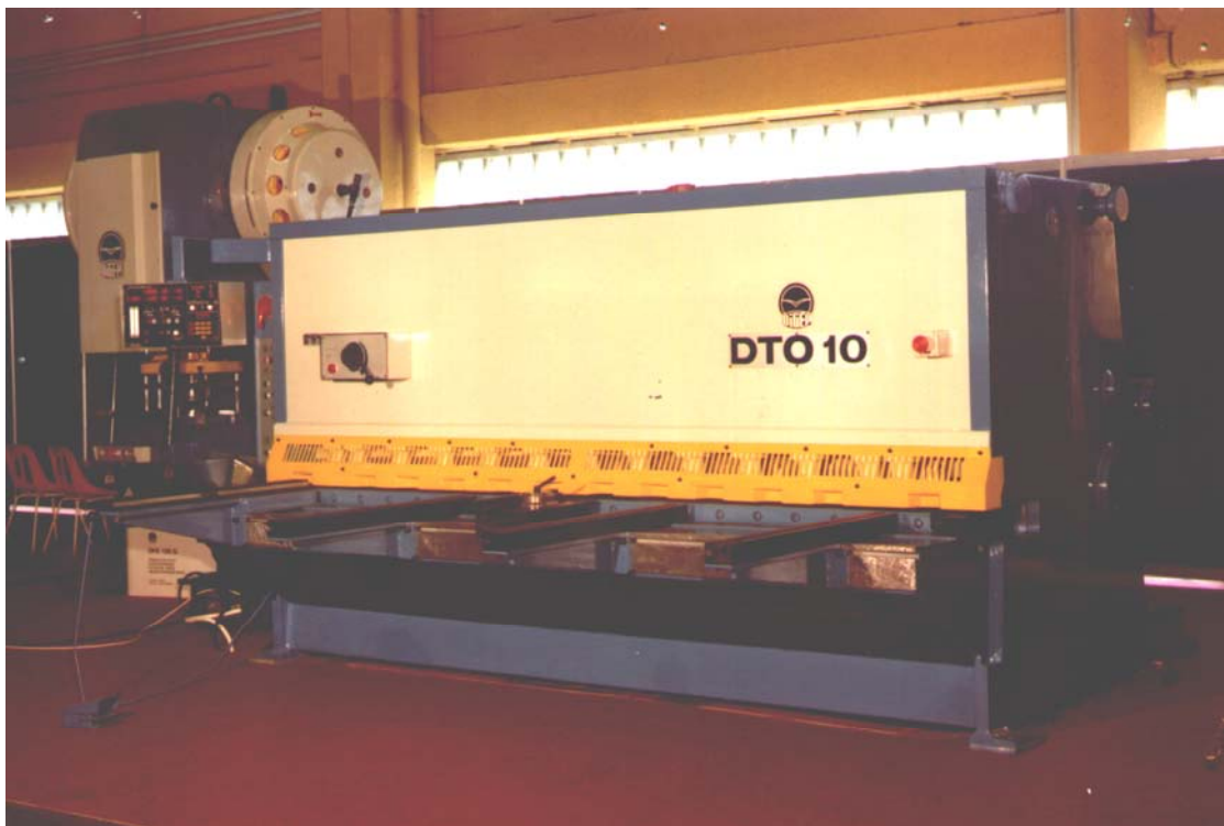
11.4 ábra A DTO 10 lemezolló a kifejlesztett numerikus vezérléssel a Budapesti Nemzetközi Vásár 1981.
