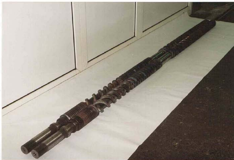
Szerelt kivitelű hengeres csigapár javítása. Javított üzemképes csigapár.
