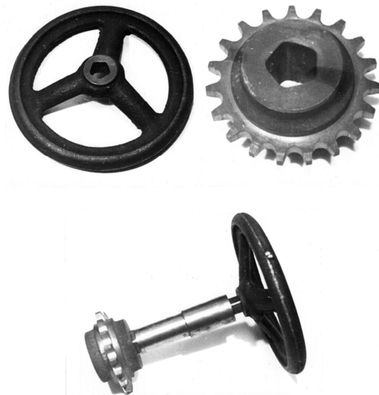
3.4. ábra Mezőgazdasági gépalkatrészek nyomatékátvivő felületeinek áttervezése sokszög felületekre Megbízó: Budapesti Mezőgazdasági Gépgyár Makói Gyára (tervezés)
