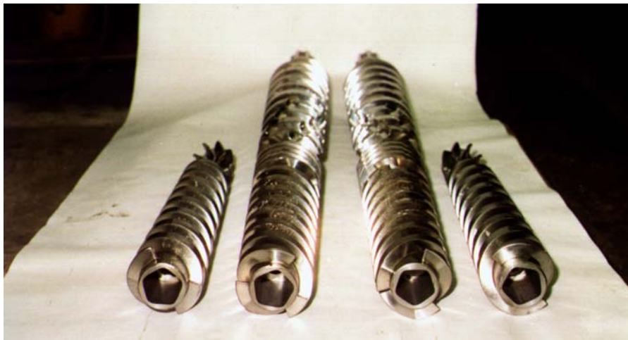
38.4 ábra Szerelésre előkészített csigaelemek
