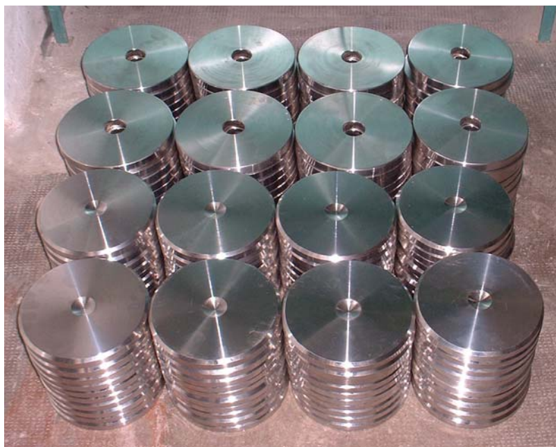
94.1 ábra Talplemez és fenékplemez alkatrészek Anyagminőség: 1.4301 (X4CRNI19-11) ausztenites saválló és korrózióálló acél
