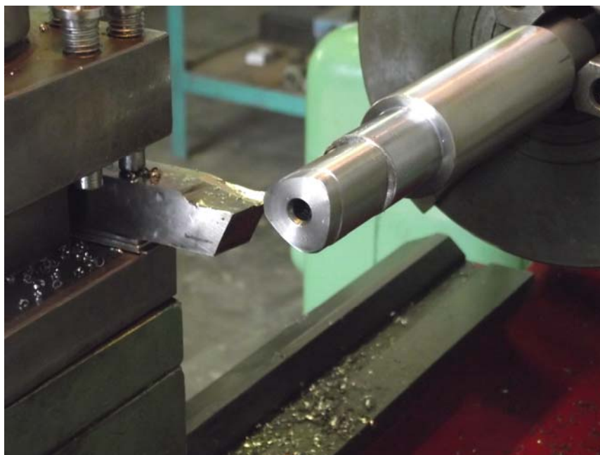
99.2 ábra Tengely HHE3 Helygon sokszögfelületének megmunkálása
