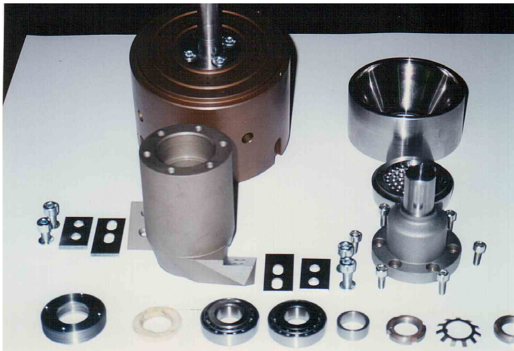
66.1 ábra Szerelésre előkészített BT 50 granuláló szerszám alkatrészek
