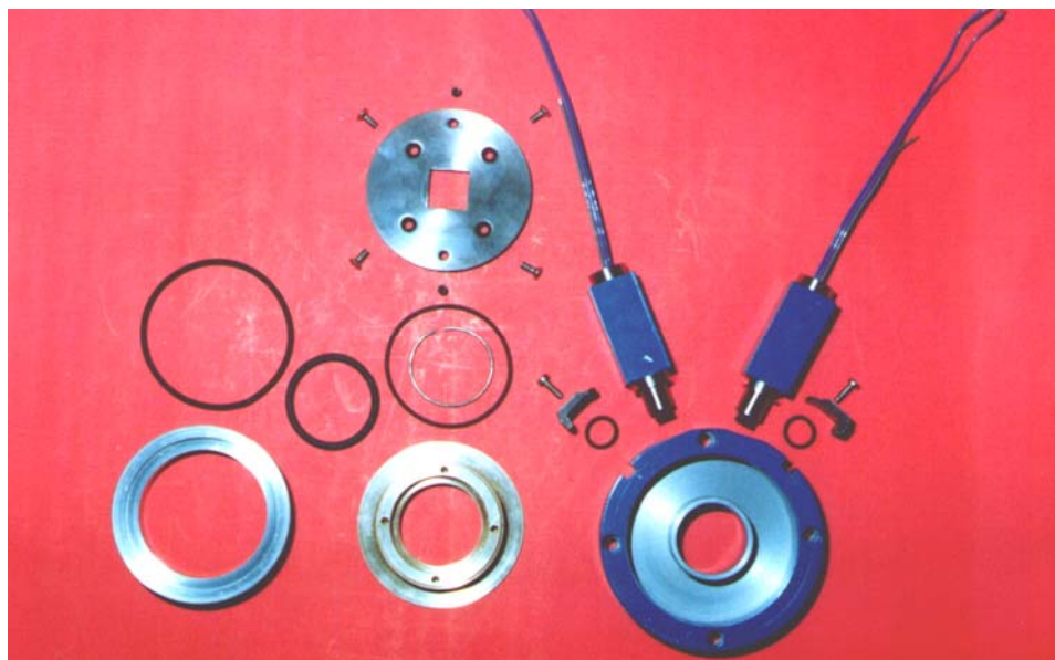
23.2 ábra Villamos helyzetávjelző, szétszerelt állapot
