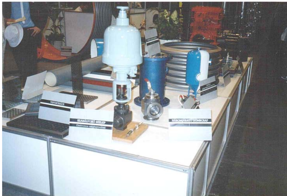
21.4 ábra Szabályozó szelep és robbanásbiztos villamos végrehajtó szerv. Háromjáratú gömbcsap Budapesti Nemzetközi Vásár 1990. Megbízó: Vegyészter Budapest
