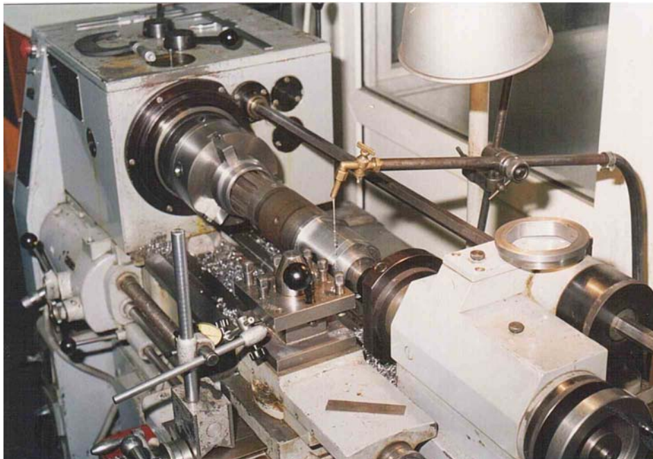
40.2 A bordáscsonk toldat megmunkálása munkadarab-mozgatású sokszögesztergán
