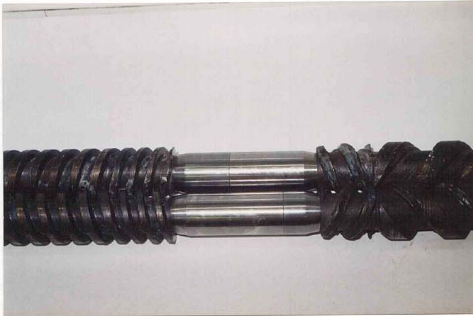
Szerelt kivitelű hengeres csigapár javítása. A kész toldás helye.
