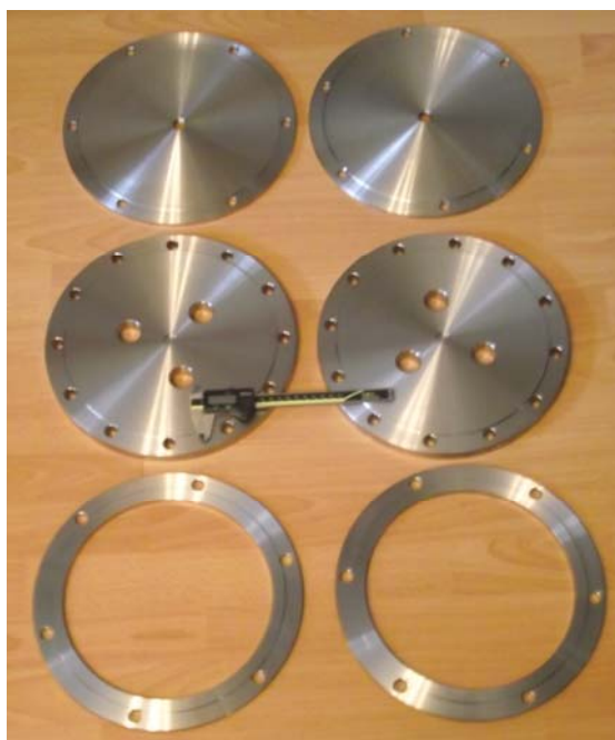
95.1 ábra Kondenz tartály alkatrészek Anyagminőség: 1.4301 (X4CRNI19-11) ausztenites saválló és korrózióálló acél
