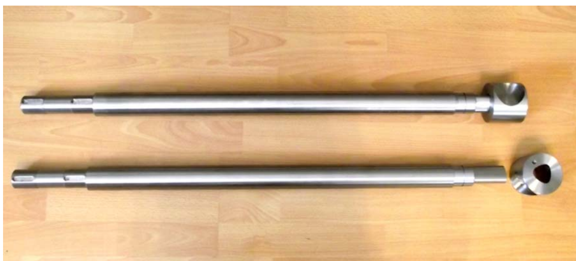
98.2 ábra Megmunkált Főtengely és Késrendszer agy alkatrészek
