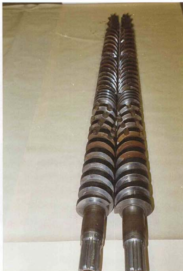
Csigajavítás tengelycsonk toldással. Javított csigapár.
