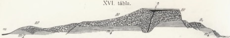
34. ábra. Szelvény az óvári szőlők sziklapárkánya mentén, az Attiladomb és a Remetelakások között, Tihanyfélsziget felépítésének magyarázatául. Mérték 1 : 8000 (1 : 1).
