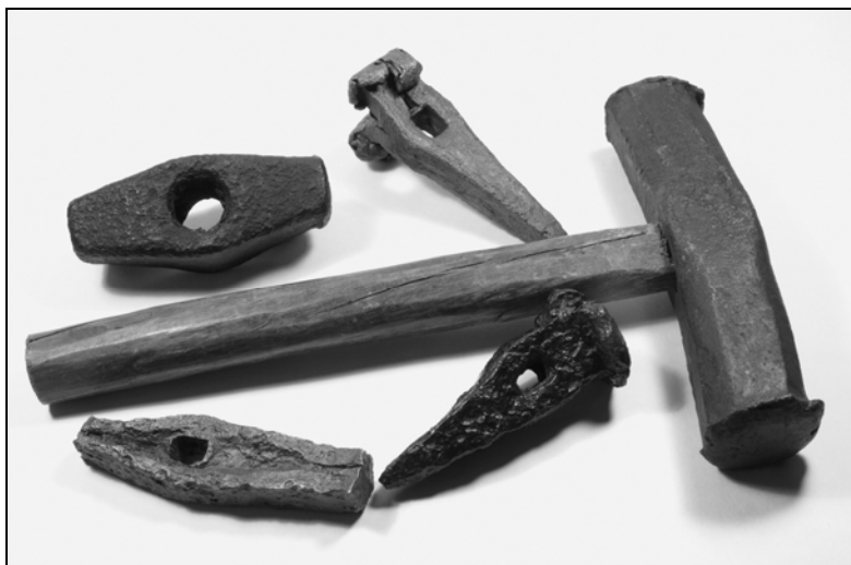
Kladivá, železská a klíny používané na rozpojenie hornín. (Foto: Banícke múzeum v Rožňave.)
